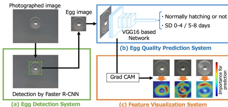
図 1.顕微鏡で撮影されたクロマグロの卵から深層学習を用いて卵質を予測・解析するシステムの全体像。(a)顕微鏡で撮影された画像から卵のみを抽出。(b)深層ニューラルネットワークを用いて卵質（正常ふ化であるか否か、無給餌生残日数が 5 日以上か否か）を予測。(c)予測に貢献した部位を可視化。
