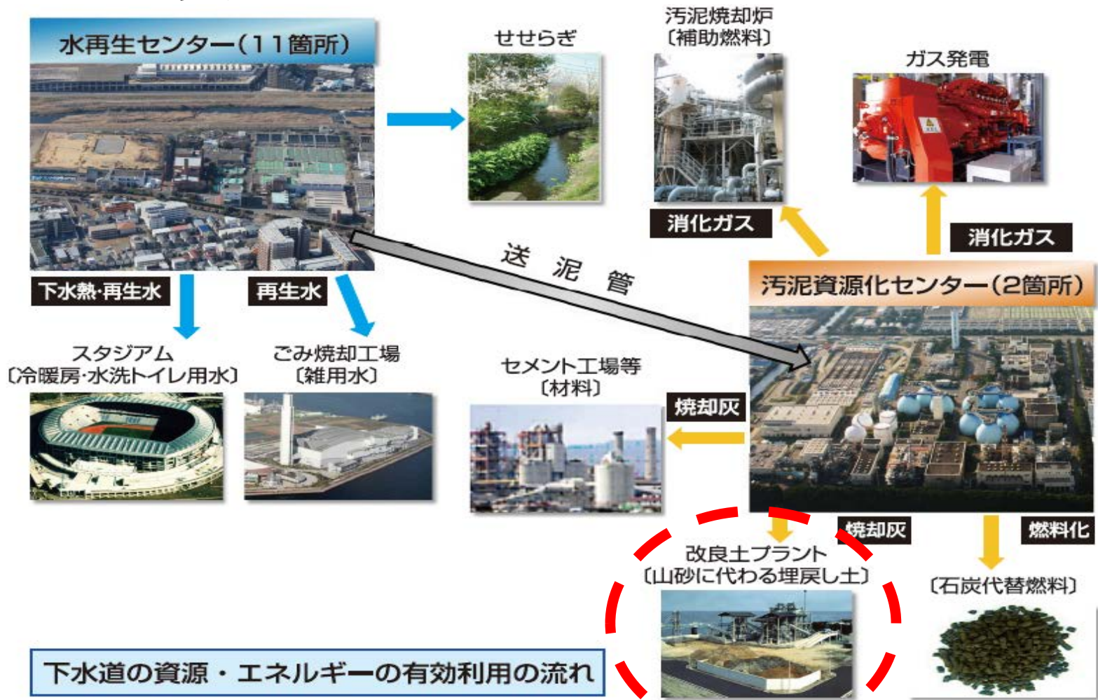
図. 2 横浜市における下水道の資源・エネルギーの有効活用
