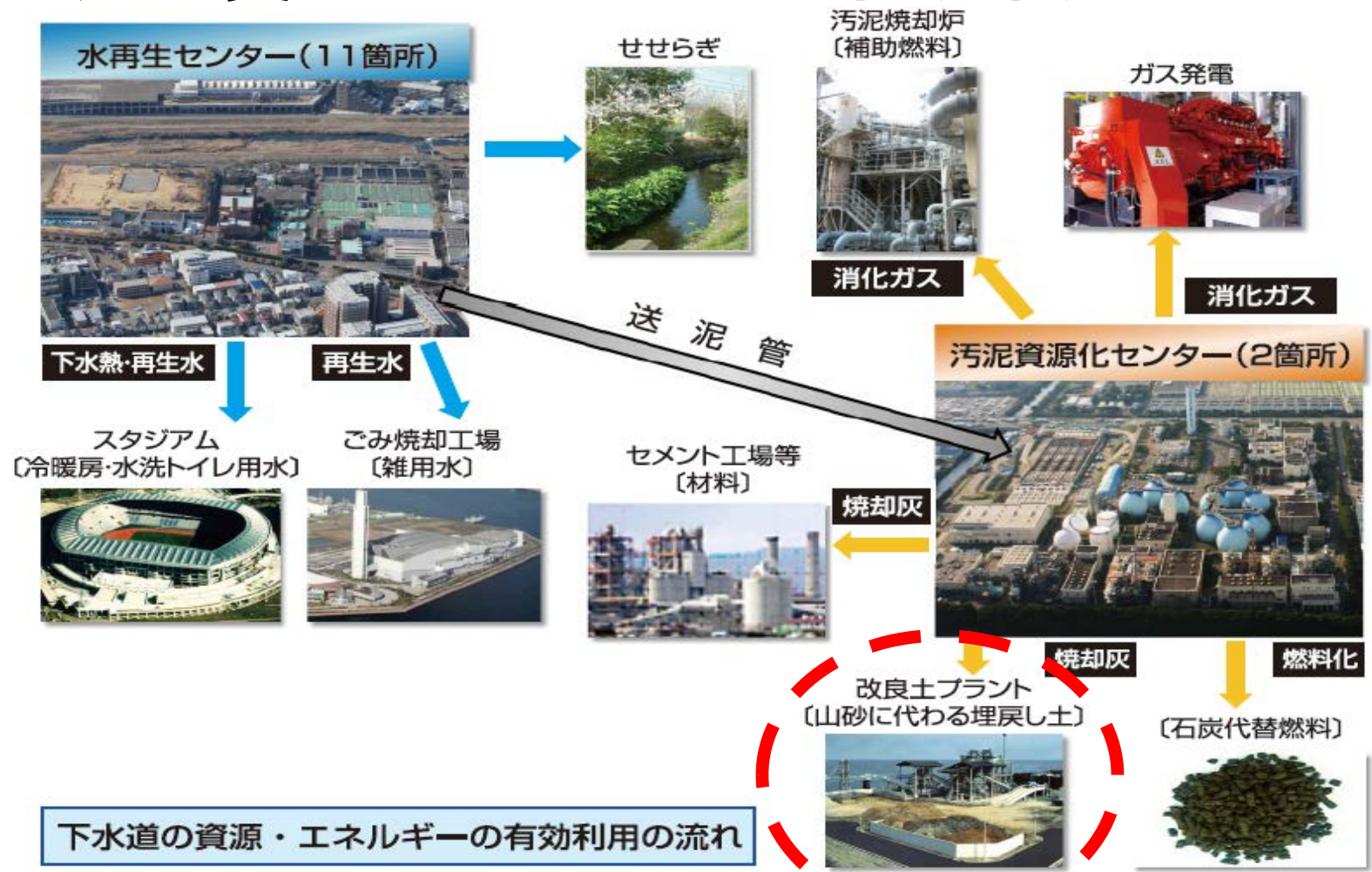
図. 2 横浜市における下水道の資源・エネルギーの有効活用 出所:横浜市環境創造局(2015)『横浜市下水道事業「中期経営計画2014」 (平成26-29年度)概要版』p.7
