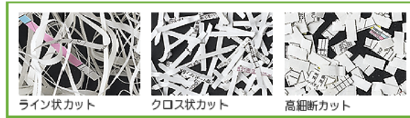
ライン状にカットされた紙片拡大図（繊維が切れている）
