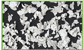
Trust-Eco 1500の紙片拡大図（繊維が残っている）
