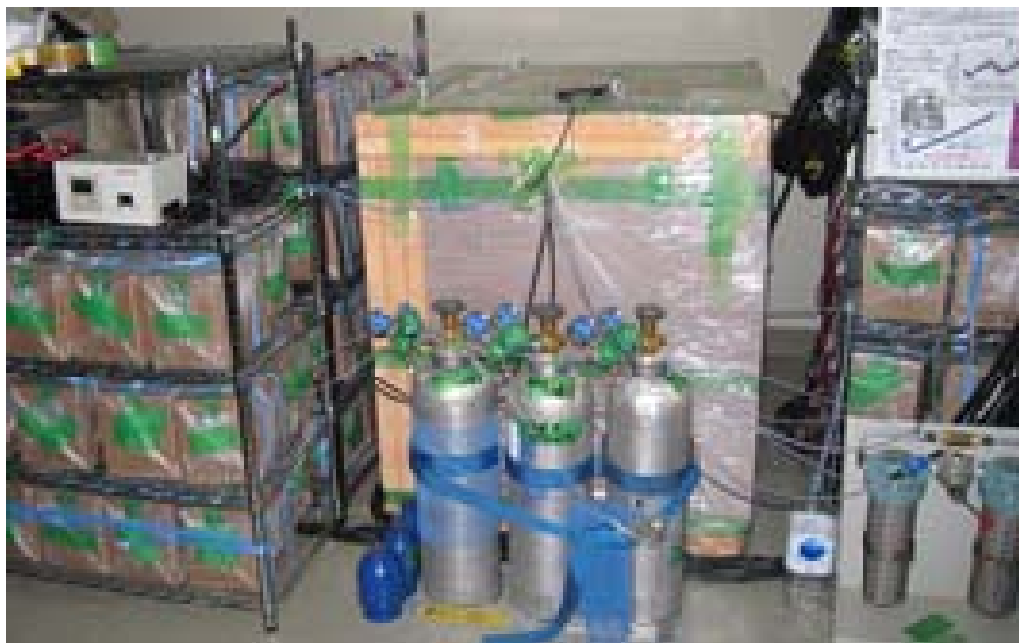
長期観測用の CO 2 濃度計測機器一式 (無人バッテリー測定9月—翌年6月)
