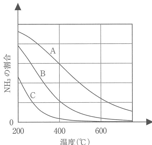
図1 一定の圧力で温度を変化させた場合の、平衡状態でのNH<sub>3</sub>の割合
