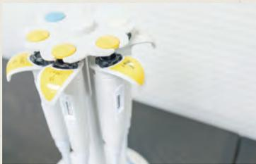
試薬の調整に用いるピペットマン。実験作業を行うにあたりなくてはならない必需品で、毎日使用している。すべて同じように見えるが、それぞれで薬液の吸入・吐出量が異なるため、調整を行いたい量によって使い分ける。
