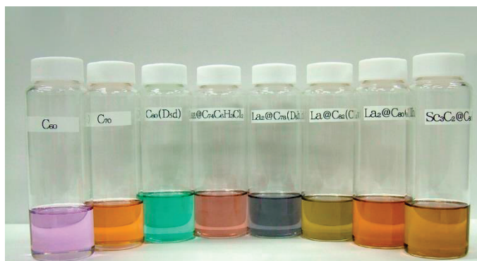
カラフルなフラーレン (右から、 C_{60} , C_{70} , C_{80} , La@C_{74}C_6H_3Cl_2 , La_2@C_{78} , La@C_{82} , La_2@C_{80} , Sc_3C_2@C_{80} )
